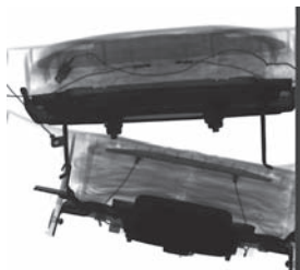
Рентгеновский снимок подушки безопасности автомобиля (получен на установке X-Cube Compact 225)
